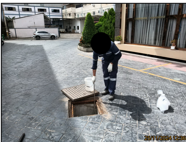
รูปที่ 3-3 การเก็บตัวอย่างน้ำทิ้งจุดที่ 3 บริเวณบ่อกักน้ำใสหลังออกจากระบบบำบัดน้ำเสีย (อาคาร A)
