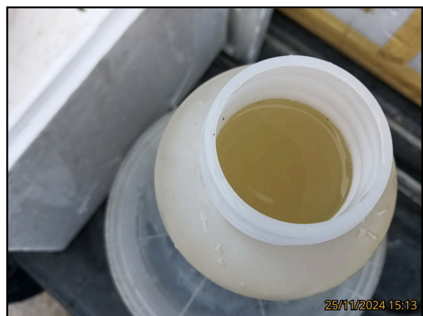
รูปที่ 3-3 การเก็บตัวอย่างน้ำทิ้งจุดที่ 3 บริเวณบ่อกักน้ำใสหลังออกจากระบบบำบัดน้ำเสีย (อาคาร A)
